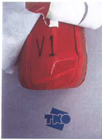
Figuur 7 Typisch resultaat na een valproef
