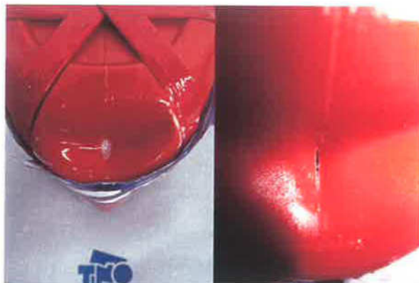
Figuur 8 Opsengescheurd exemplaar
