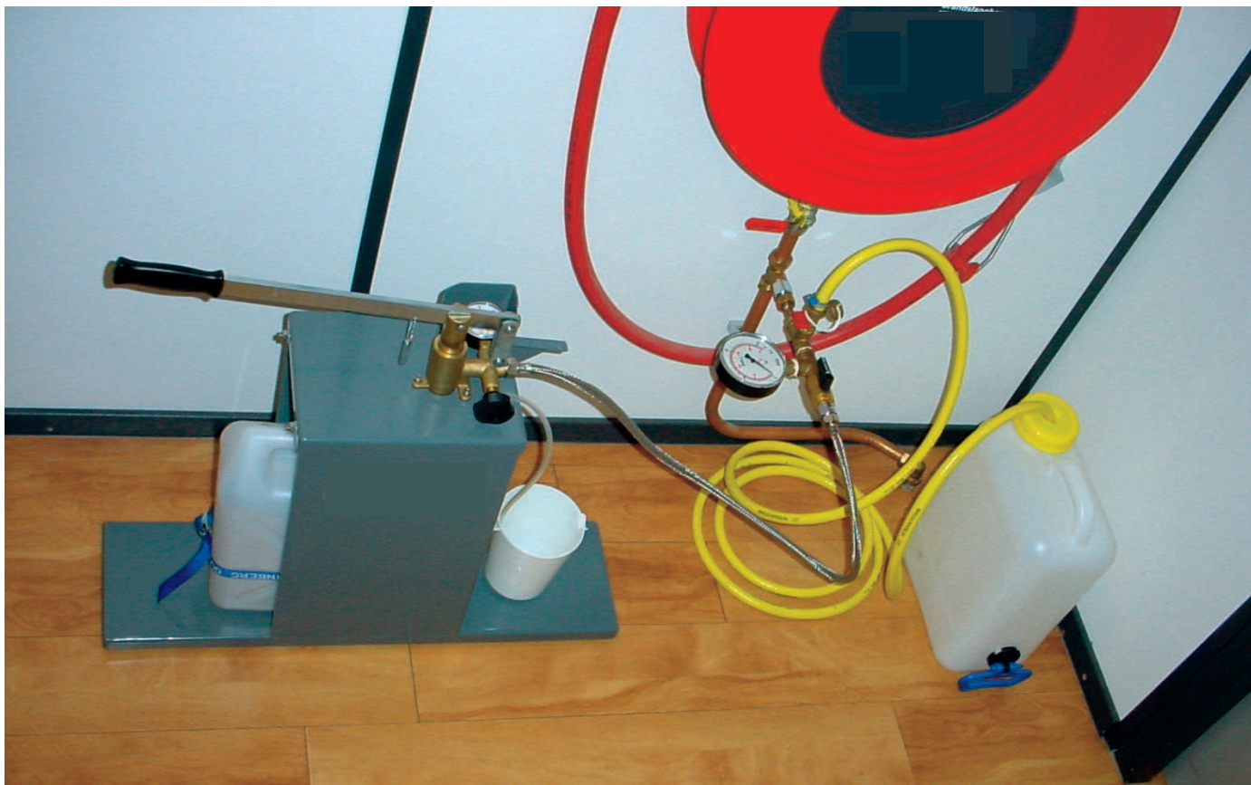
1. Opstelling handperspomp met toebehoren voor gebruik bij overdrukmethode.
